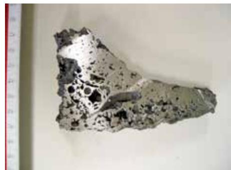
d. 脱炭生成物の断面 (図5に対応)
