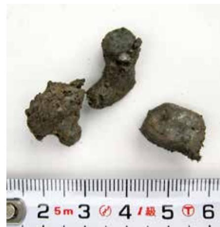
b. 溶融・滴下後ただちに回収した小鉄塊
