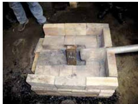
a. 原料を設置した開放炉
