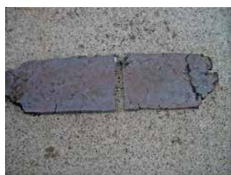
写真17 日刀保の銛を使用した再現操業の生成物を折り返し鍛錬したもの
