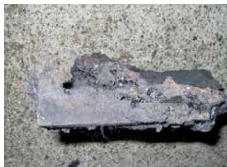
c. 表面層のみが残存していた原料脚部
