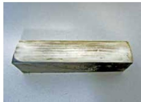
d. c の試料を鏡面研磨し、エッティングしたもの
