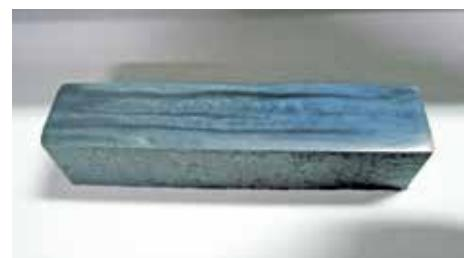
b. a の試料を鏡面研磨し、エッティングしたもの
