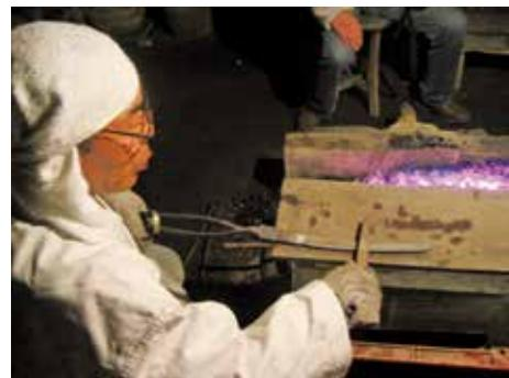
写真10 焼刃土を剥がしている様子
